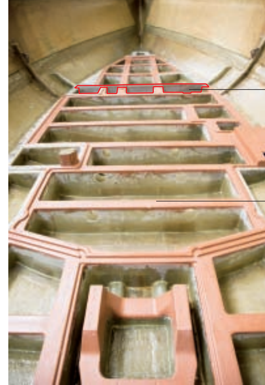
verstärkte und anlaminierte Bodenwrangen
